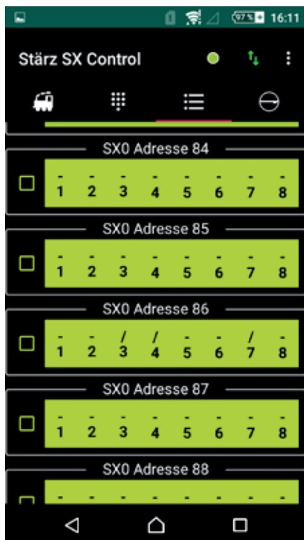
Über das dritte Icon wird der SX-Monitor geöffnet. Mit ihm lassen sich alle Selectrix-Adressen überwachen und ändern.
