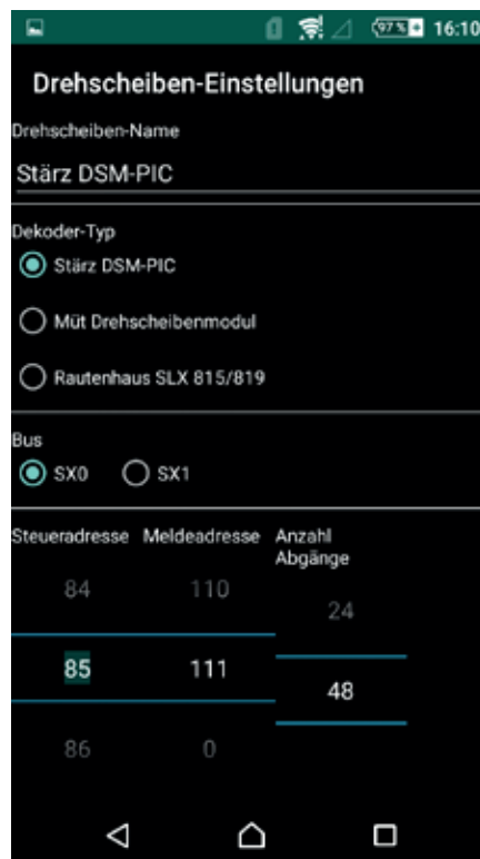
Auch die Steuerung von Drehscheiben über drei verschiedene Selectrix-Drehscheibenmodule ist möglich.
