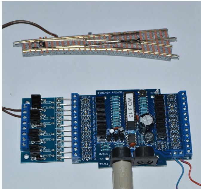
Für den Anschluss muss unbedingt der WDMiba 3 oder WLFD 3 mit Freilaufdioden benutzt werden. An den Decoder wird zusätzlich das EP-WDMot angeschlossen.
