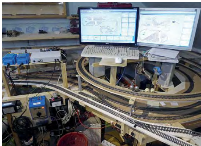
Provisorischer Leitstand der Anlage mit Zentralen, Stromversorgung und zwei Bildschirmen. Mit der nächsten Anlagenerweiterung soll der Leitstand komplett neu aufgebaut werden.
