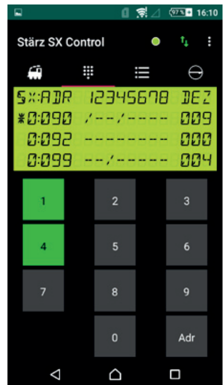
Im Menü <Schalten> hat man direkten Zugriff auf drei frei wählbare Schaltadressen. Die aktive Adresse ist gekennzeichnet.
